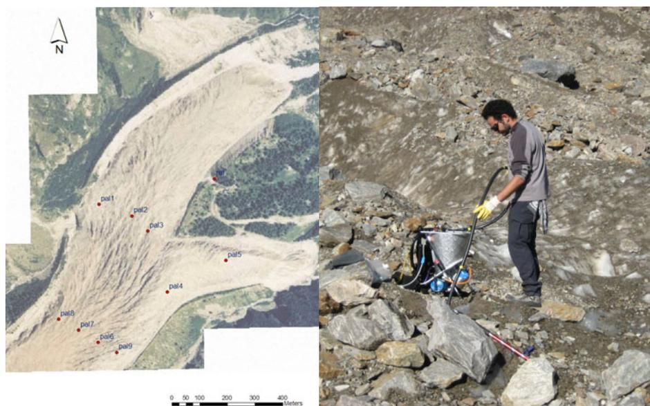
Figura 2 – Localizzazione delle paline ablatometriche e installazione nel ghiaccio mediante sonda a vapore
