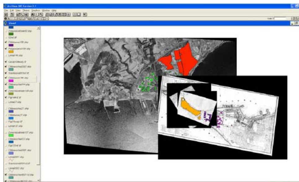
Figura 2 – Visualizzazione e vettorializzazione delle immagini cartografiche in ambiente GIS
