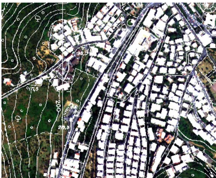
Figura 3 - Sovrapposizione fra la scena MIVIS e la cartografia CTR
