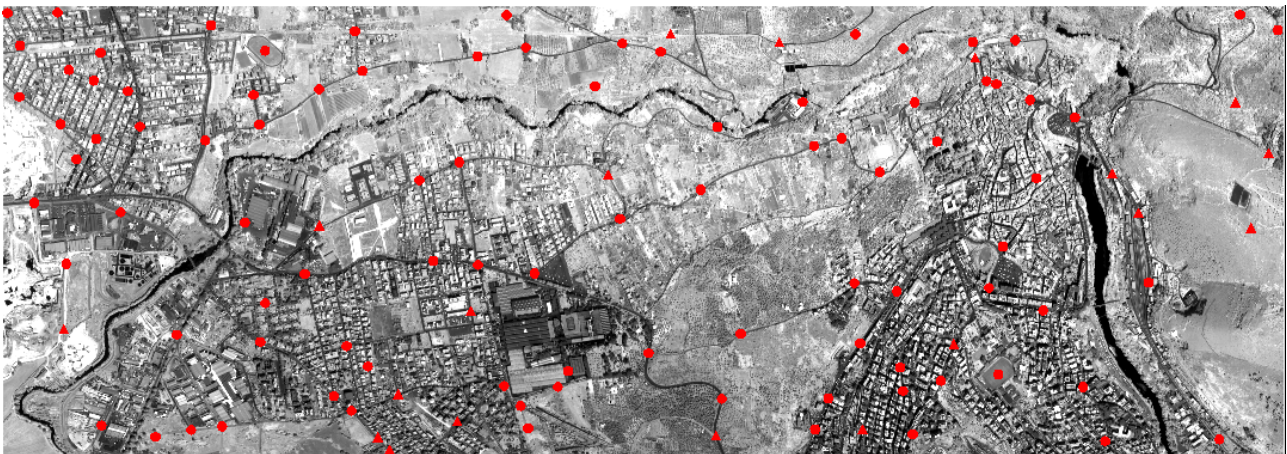
Figura 1 – Tivoli, Collocazione dei punti di controllo GCP e CP nella scena MIVIS
