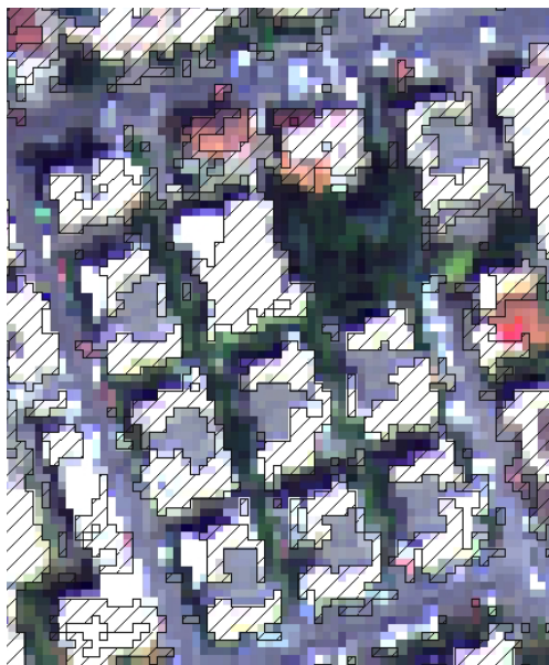
Figura 4 – Shapefile dell'edificato su immagine MIVIS ortorettificata
