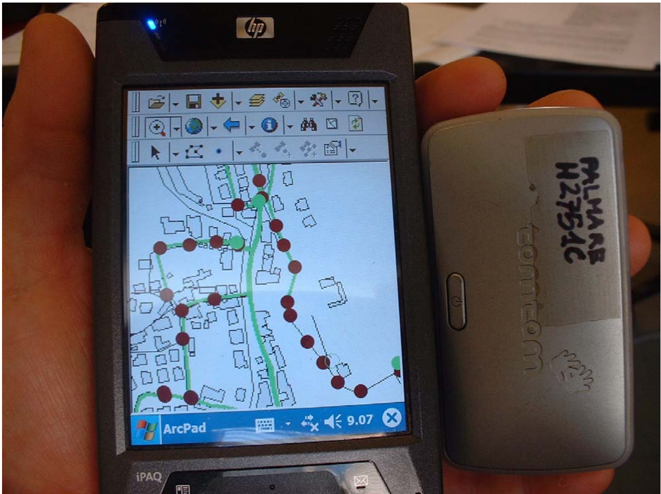
Figura 1- Il palmare iPAQ e il ricevitore GPS della TOM TOM. L'antenna è un oggetto a se stante che può distare qualche metro dal palmare.
