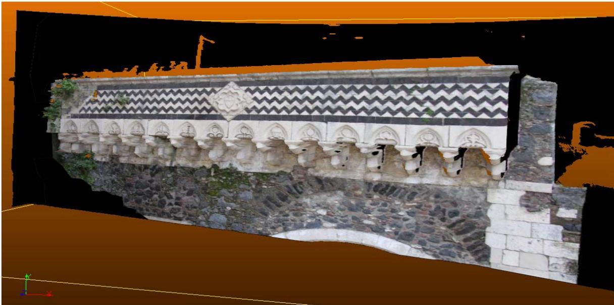
Fig. 4 - Proiezione dell'immagine fotografica sulla mesh
