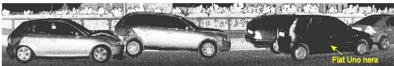
Figura 1- Rilievo di un incidente stradale sulla A22 con laser scanner Riegl LMS-Z360i.
