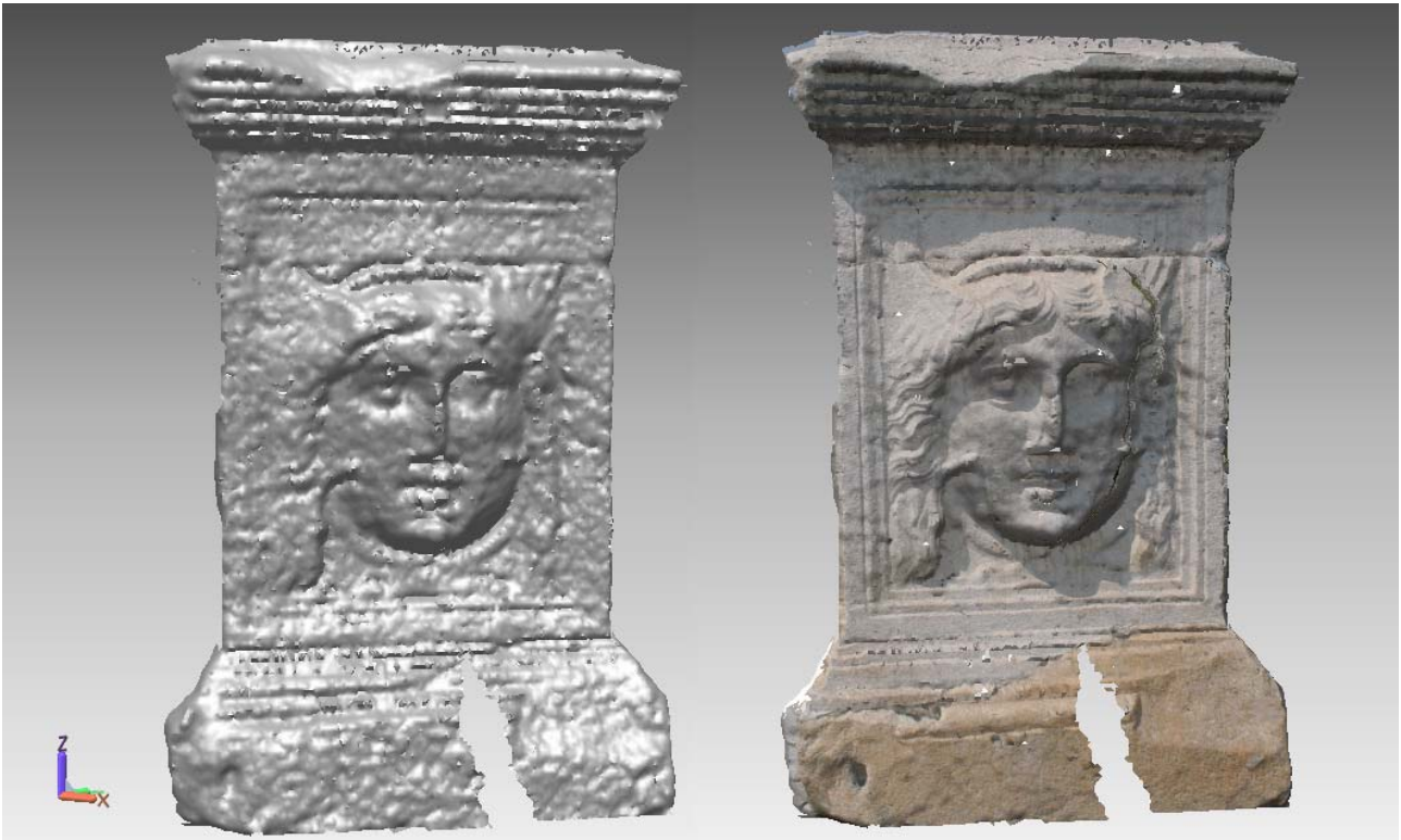
fig.6 Triangolazione ottenuta da dati laser scanner e ridotta al 10%
