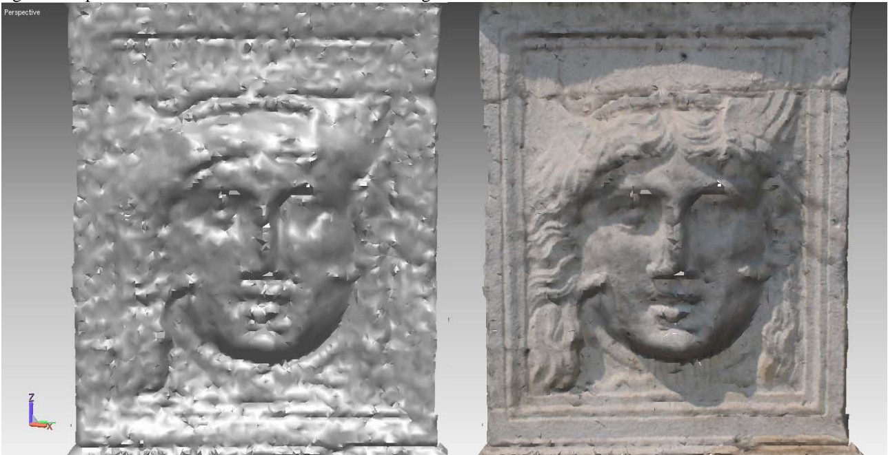
fig.5 Triangolazione ottenuta da dati laser scanner e ridotta al 25%
