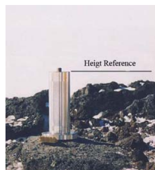
Figura 1 - Pilastrino in acciaio prototipo dei vertici geodetici della rete VLNDEF
