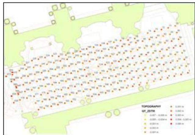
Fig. 6 Confronto tra i punti di controllo di livellazione e le quote estratte dal DTM fotogrammetrico
