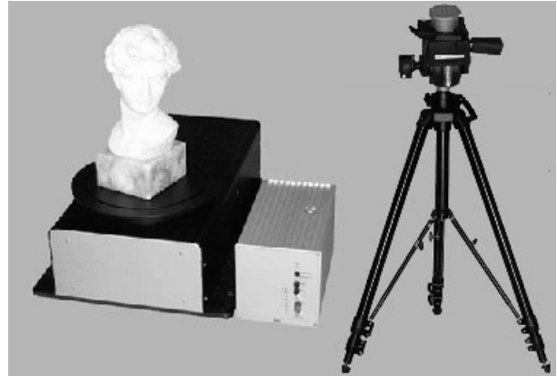
Figura 3 – Laser Scanner VI-9i Minolta e strumentazione accessoria.
