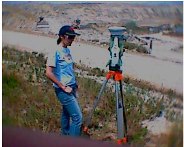
*Fig 1-La Smart station in fase di scansione automatica*
