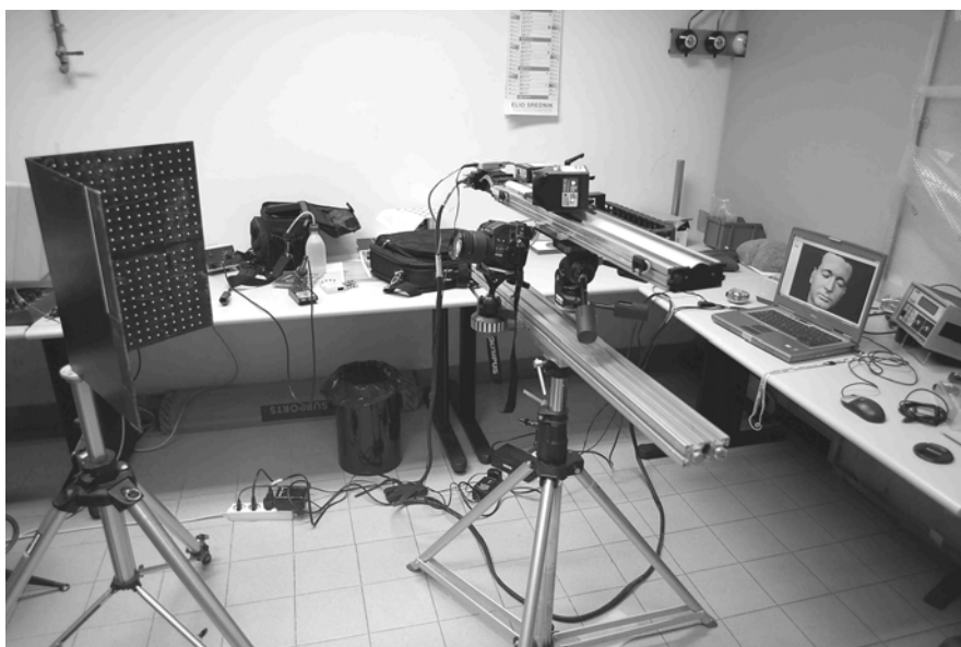
Figura 3 – Calibrazione del sistema laser scanner-fotocamera
