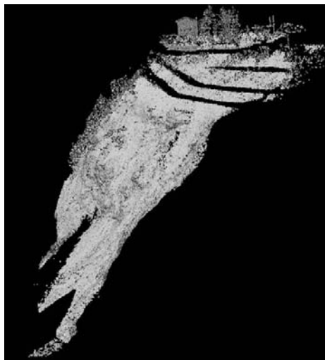
Figura 3 - Nuvola di punti della frana di Perarolo di Cadore, acquisita con TLS Optech, vista da sud.
