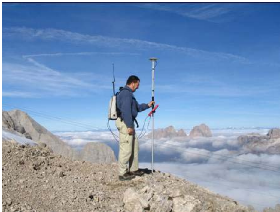
Figura 4: Rilievo GPS in modalità RTK sulla Marmolada.
