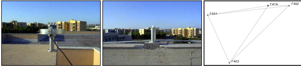
Figura 2 – Stazione permanente FATA (a sinistra), marker utilizzato nella rete di controllo locale (al centro) e schema della rete per l'inquadramento locale (a destra)
