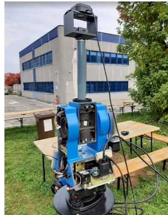
Fig. 2. Goniometro progettato e realizzato per le campagne di test
