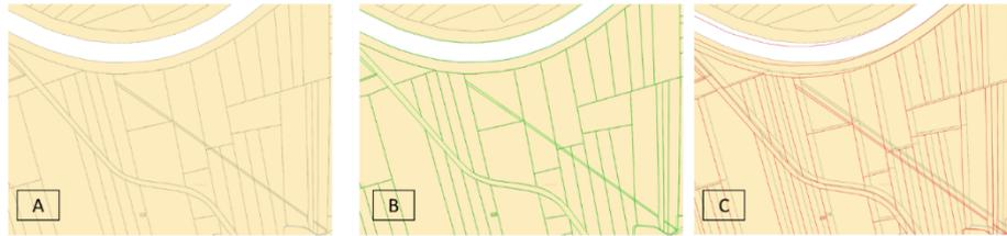
**Fig. 1.** Georeferenziazione del dato catastale: dato dell'AdE (pannello A); dato georeferenziato (linea in verde), sovrapposto al dato dell'AdE (pannello B); dato prima della georeferenziazione (linea in rosso), sovrapposto al dato dell'AdE (pannello C).
