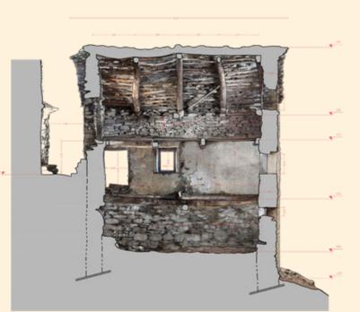
Esempi di disegni architettonici a supporto delle attività progettuali, realizzati a partire dalle nuvole di punti fotogrammetriche.
