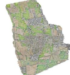
**Classificazione automatica** della nuvola densa di punti in Ground, High Vegetation, Building, Road Surface, Car, Man-made Object. I punti "Ground" sono stati impiegati per definire il DDTM (*Dense Digital Surface model*, passo 5 cm, 28 Gb), mentre i punti "High Vegetation" e "Building" hanno portato alla restituzione automatica degli alberi e dei tetti.
