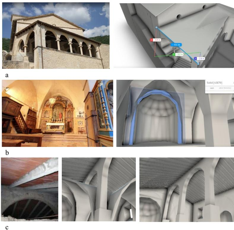
Fig. 7. Alcuni esempi di operazioni effettuabili sul modello condiviso su Autodesk Viewer. **a)** Misurare degli elementi, **b)** individuare degli elementi e visualizzazione delle proprietà come il macroelemento di appartenenza, **c)** occultare alcuni elementi, ad esempio porzioni di volta.
