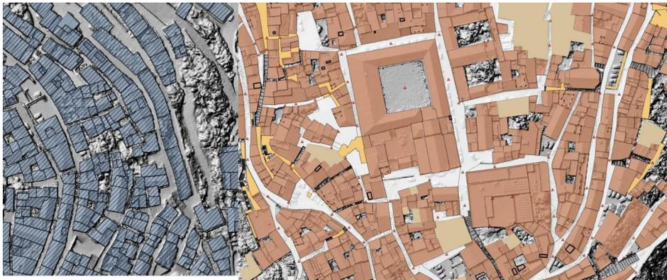
**Fig. 3.** Alcuni step della costruzione delle geometrie per LOD0 e LOD1 del geodatabase 3D e una visualizzazione di alcuni degli elementi cartografici generati
