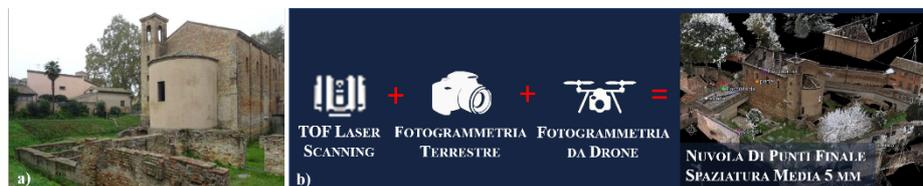
**Figura 1.** Il complesso di Santa Croce, con la chiesa e l'area archeologica (a); le tecniche di rilievo utilizzate per l'acquisizione della nuvola di punti (b).
