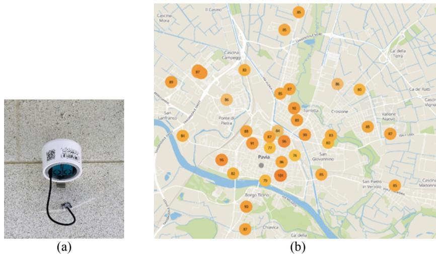
Fig. 1. Esempio di sensore istallato presso la Facoltà di Ingegneria (a); Mappa della rete di sensori sulla città di Pavia (b).
