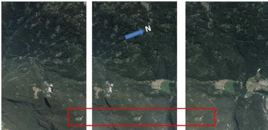
Figura 2 – Esempio di fotogrammi consecutivi con indicazione della sovrapposizione stereoscopica attraverso confronto fra elementi omologhi.
