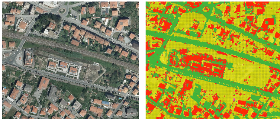
Fig. 2. Elaborazione da ortofoto digitale a colori per separazione e classificazione a gruppi di pixel con medesima firma spettrale.
