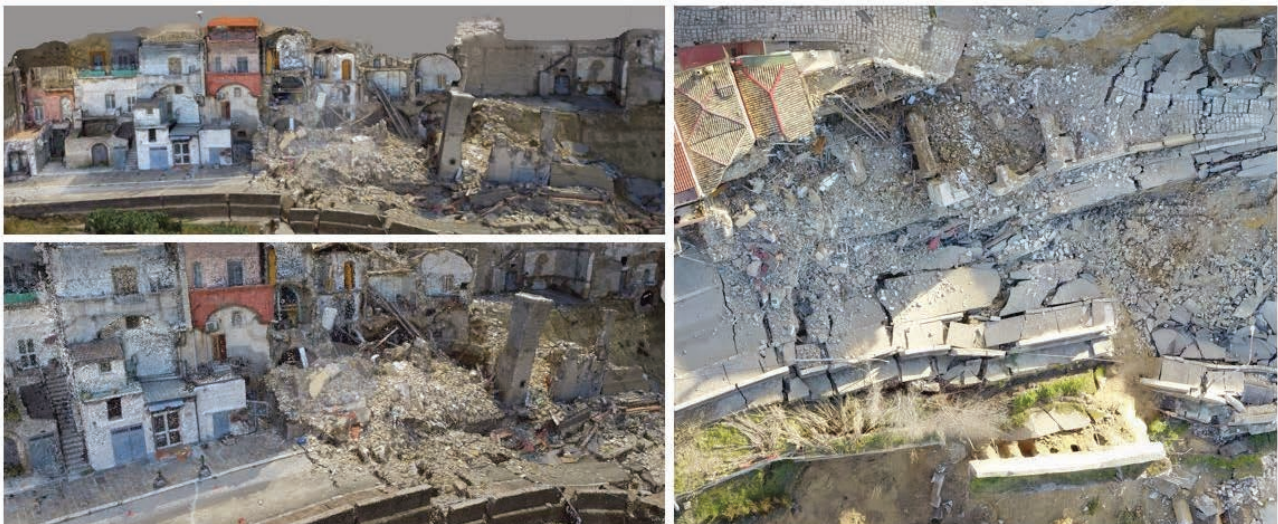
Figura 2 – Dettagli dei prodotti ottenuti. In alto a sinistra: dettaglio del modello 3D degli edifici che insistono sul fronte di frana; in basso a sinistra: dettaglio della nuvola densa di punti degli edifici; a destra: dettaglio dell'ortofoto.
