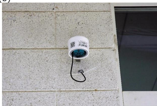
Figura 3. (a) La mappa della qualità dell'aria misurata in tempo reale e visibile tramite un'interfaccia webGIS. I dati si riferiscono alla misura del PM10 per il giorno 3 ottobre 2019. (b) Il dettaglio di un sensore installato presso la Facoltà di Ingegneria dell'Università di Pavia.
