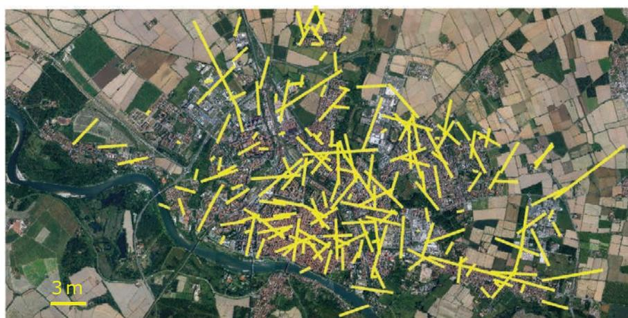
Figura 2. Analisi di accuratezza per il Comune di Pavia: in alto (a) i risultati per OSM, sotto (b) per Google Maps. Le linee indicano i residui planimetrici sui punti presi in esame
