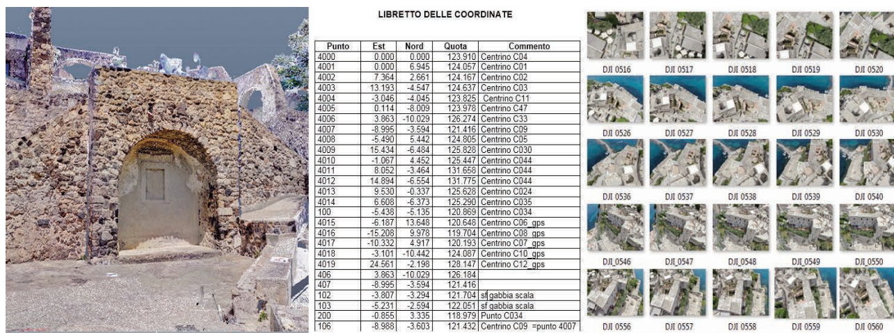
Figura 6 - Alcuni dei dati acquisiti: da sinistra, una nuvola di punti da laser, coordinate di punti battuti con stazione totale e GCP, prese fotografiche da drone
