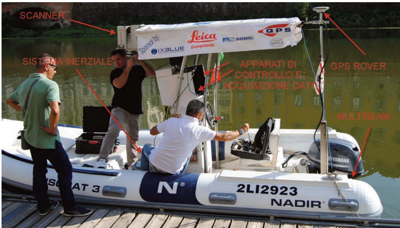
Figura 2 - Il natante e l'attrezzatura impiegata per il rilievo geomatico
