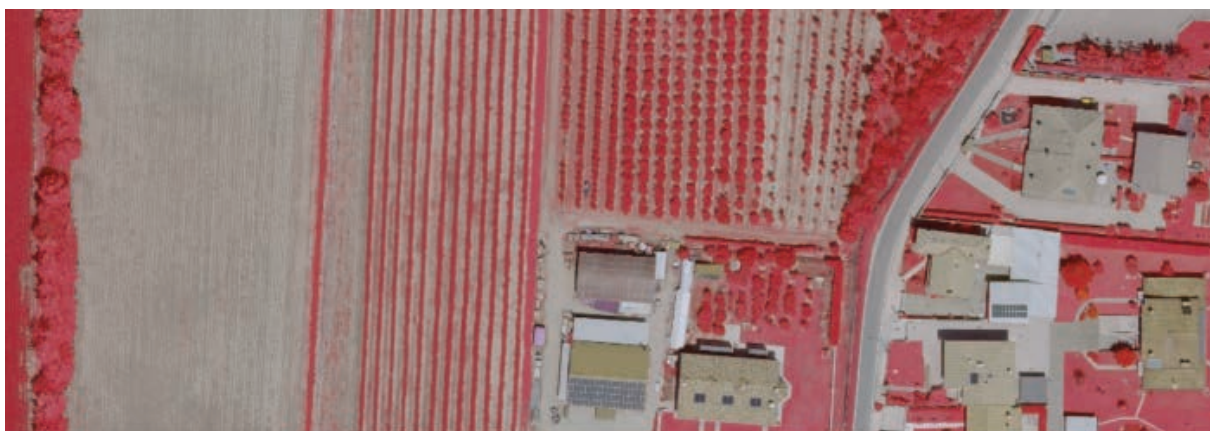
Figura 4. Ortofoto di precisione del Comune di Treviso in falso colore, zoom in zona rurale, scala 1:1.000.
