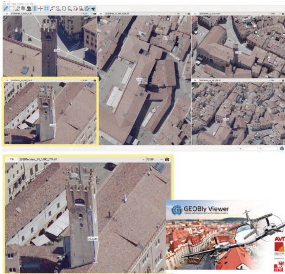
Figura 9. Software Geobly-light e misura dell'altezza di un edificio.
