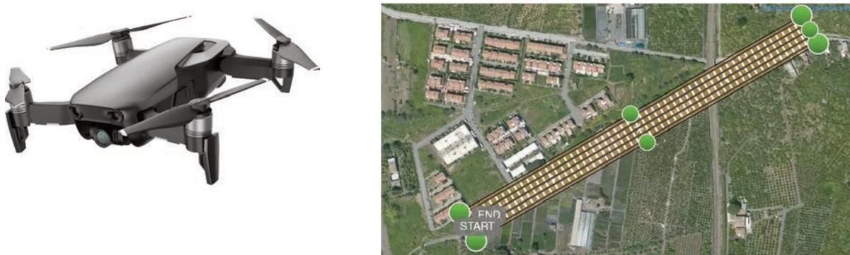
Figura 3 – UAV DJI MAVic Air e piano di volo seguito per il rilievo
