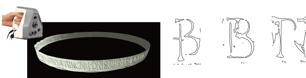
Figura 1 – A sinistra: lo scanner a proiezione di luce strutturata e modello 3D ad alta risoluzione dell'iscrizione. A destra: profili delle lettere B e R estratti alla profondità di 1 mm.
