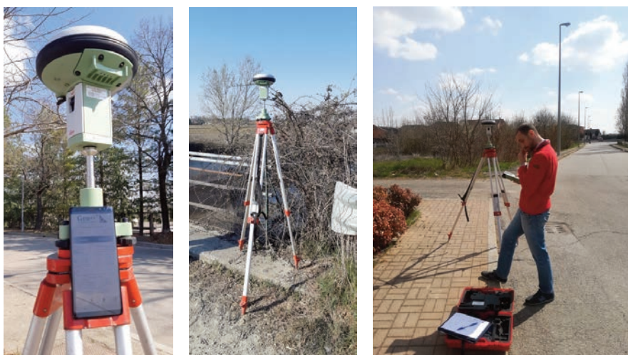
Figura 5 - Esecuzione della campagna di misura con strumentazione GNSS professionale
