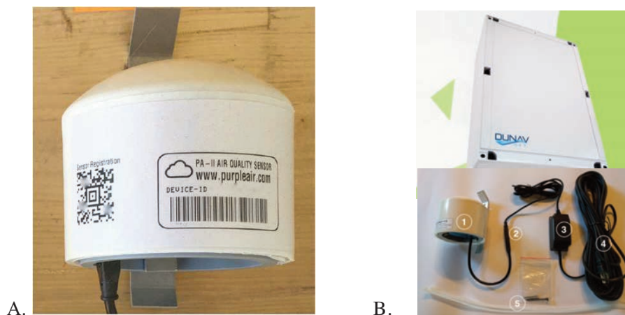
Figura 5 -Tipi di sensori della rete A. PurpleAir PA-II sensor B. AQ10x of DunavNet
