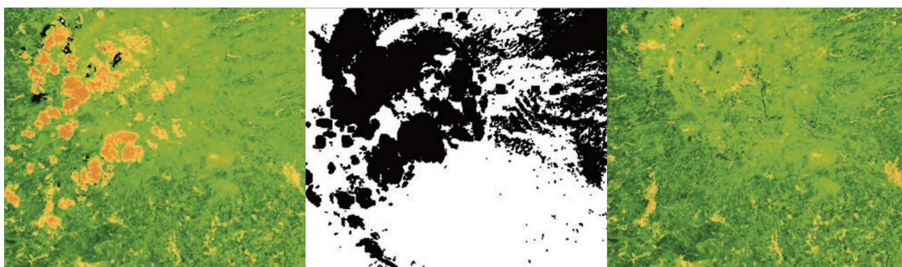
Figura 3 – Tile T33TVF (Landsat 8) acquisita nel DoY 48 (2018): NDVI originale (sinistra); Maschera binaria (Land = 1, no-Land = 0) (centro); NDVI filtrato (destra)
