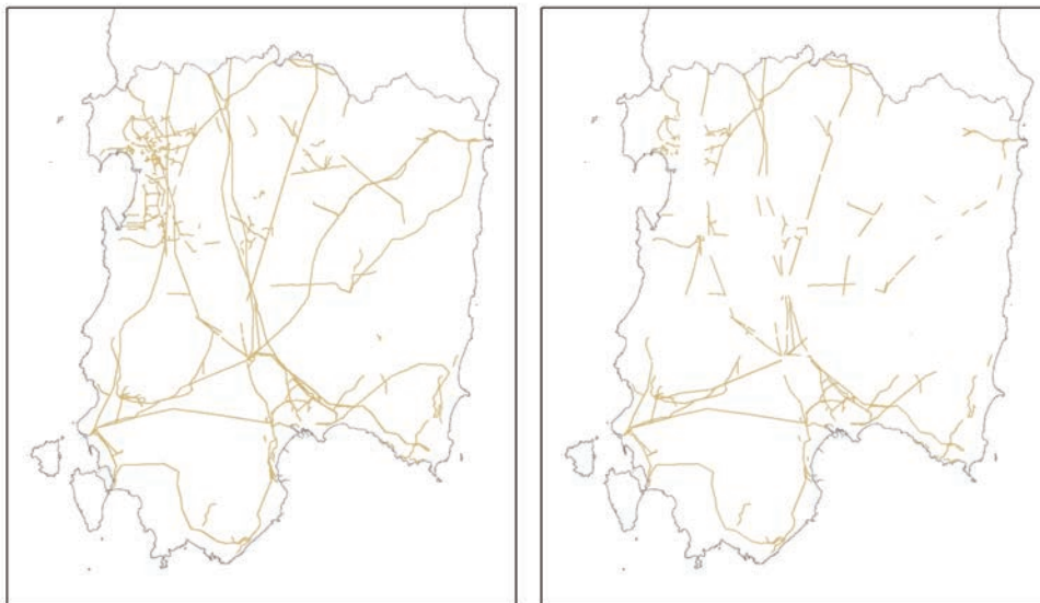
Figura 4 - A sinistra la Rete elettrica come integrata nel DBGT 10k aggiornato al 2019, a destra nella versione precedente.
