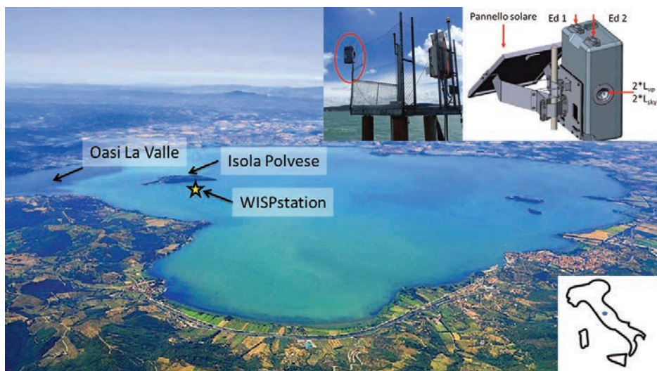
Figura 1 – Immagine del lago Trasimeno con indicazione della posizione della WISPstation in prossimità dell'isola Polvese e indicazione dell'Oasi La Valle. In alto la fotografia della WISPstation montata su piattaforma e schema della WISPstation con indicazione della posizione delle differenti ottiche.
