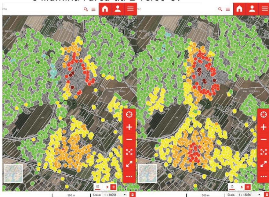
Figura 2 - Esempio di moto con componente prevalentemente verticale come la subsidenza
