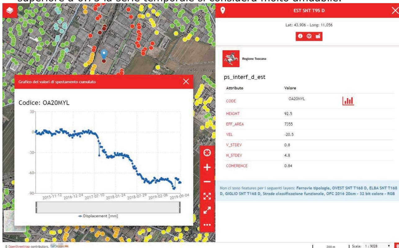
Figura 9 - Esempio di serie temporale di deformazione. In ascissa la data di acquisizione, in ordinata lo spostamento registrato in millimetri.
