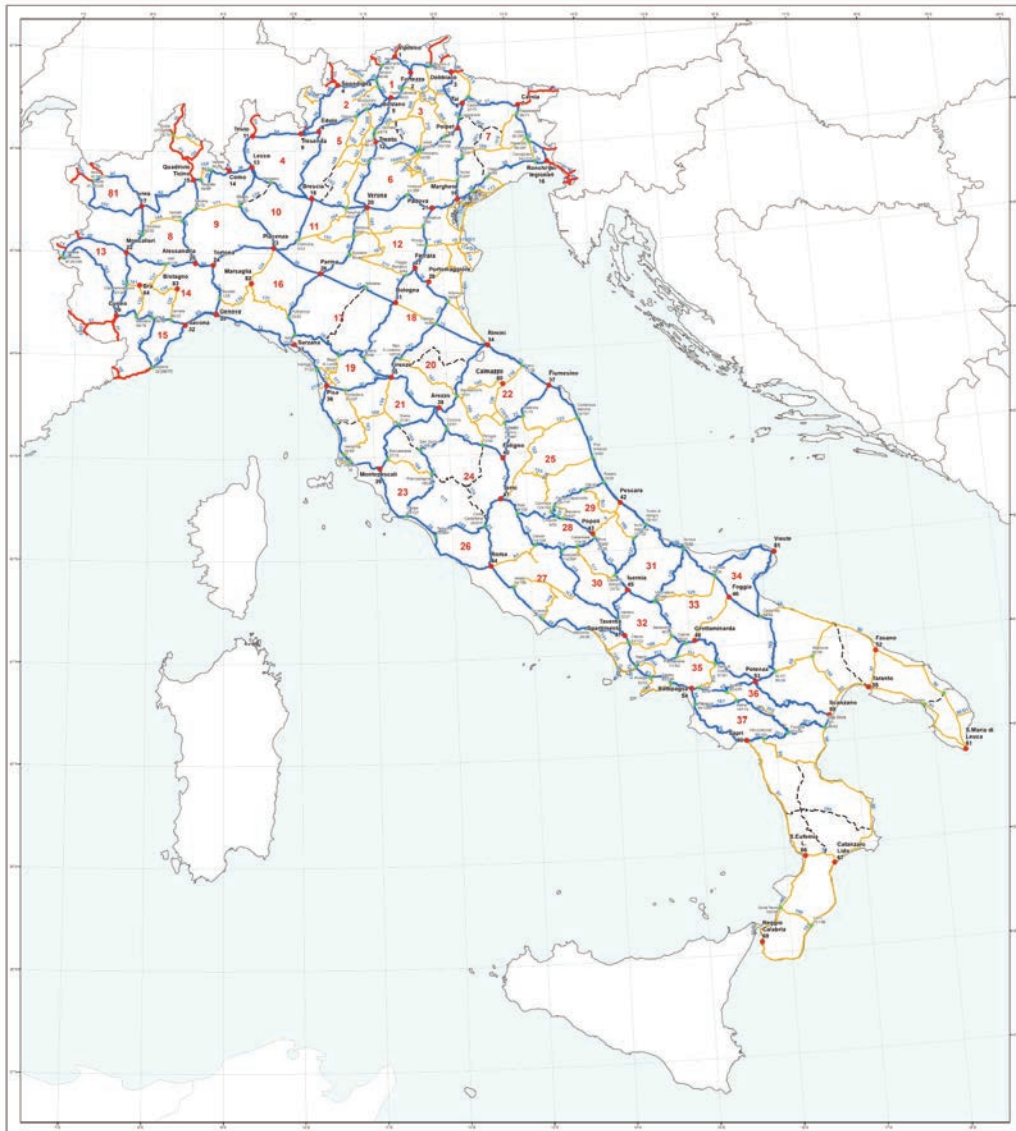
Figura 5 - In blu le linee selezionate come maglia fondamentale; in rosso le linee di collegamento con le reti europee; in arancio le linee calcolate come raffittimento.
