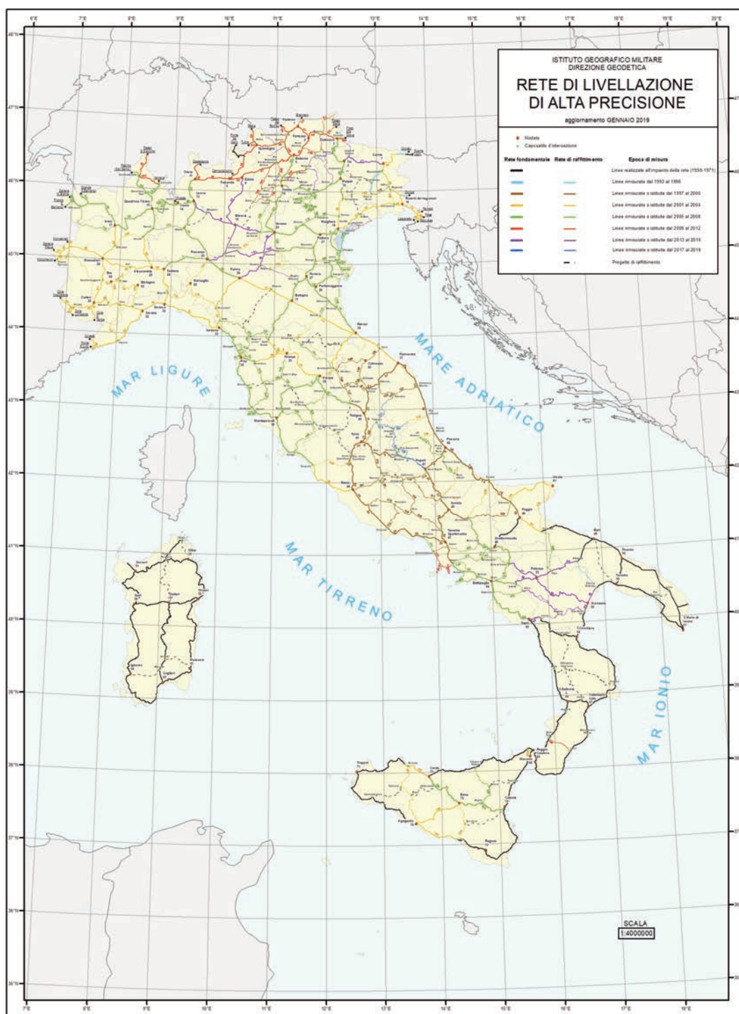
Figura 3 - Progetto di rimisura e densificazione della rete altimetrica italiana, che porterà a disporre di oltre 21000 km di livellazione di alta precisione; i colori delle linee si riferiscono al periodo della misura; in nero le linee non ancora rimisurate.
