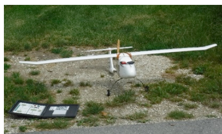
Figura 4 – SAPR AGRI-1900 ad ala fissa, in grado di trasportare la fotocamera RGB e la camera multispettrale
