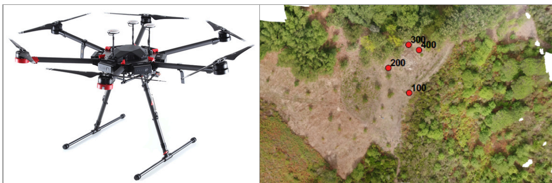
Figura 6 –UAV DJI Matrice 600 Pro e ortofoto con la disposizione dei 4 GCP.
