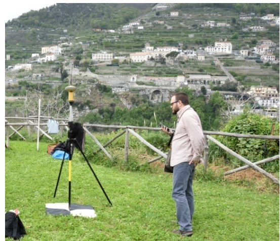
Figura 1 – (a) Schema di rilievo (b) foto dei lavori di georeferenziazione dei target
