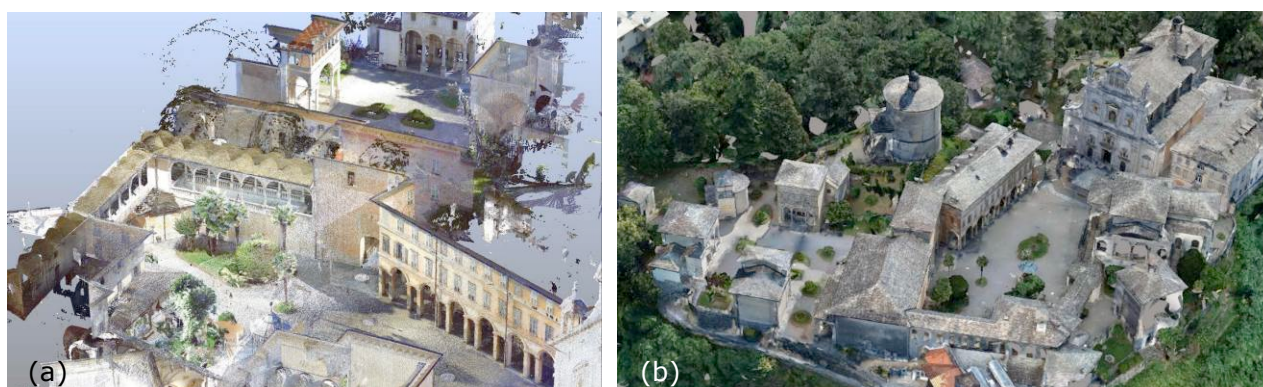
Figura 4 - Nuvola densa da tecnica LiDAR (a) e nuvola fotogrammetrica (b).
