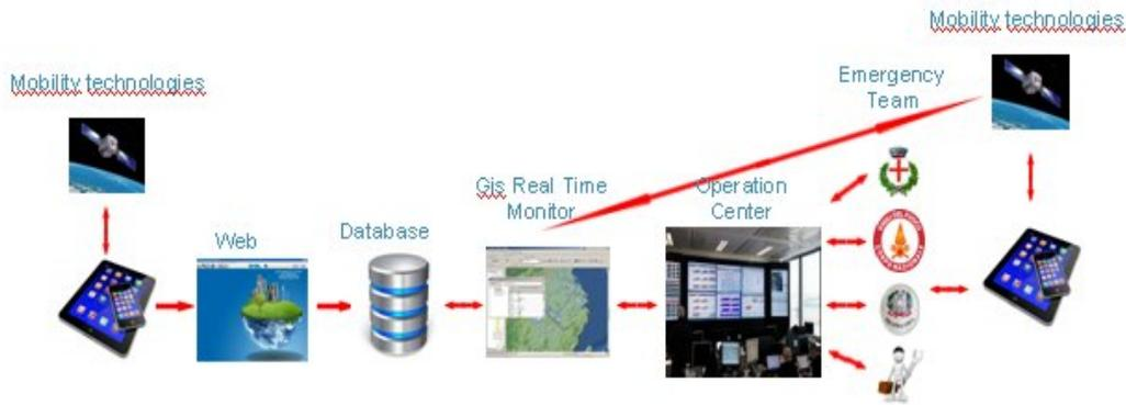
Figura 1. Schema funzionale del sistema informativo VGI-DSS
