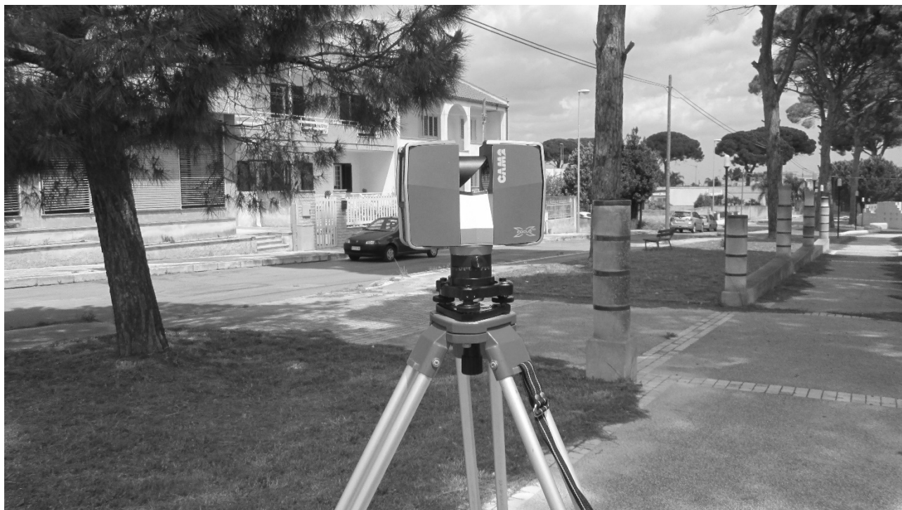
Figura 1. Rilievo dell'alberatura con impiego di un Laser Scanner terrestre.
