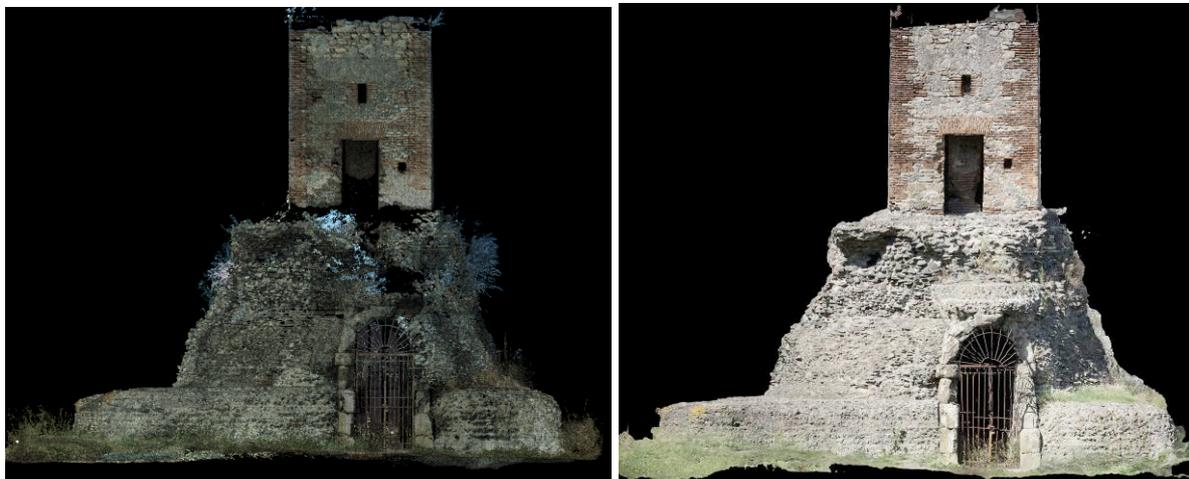
Figura 4 – Ortofoto (lato Sud-Est) da rilievo laser scanner (sx) e fotogrammetrico (dx).
