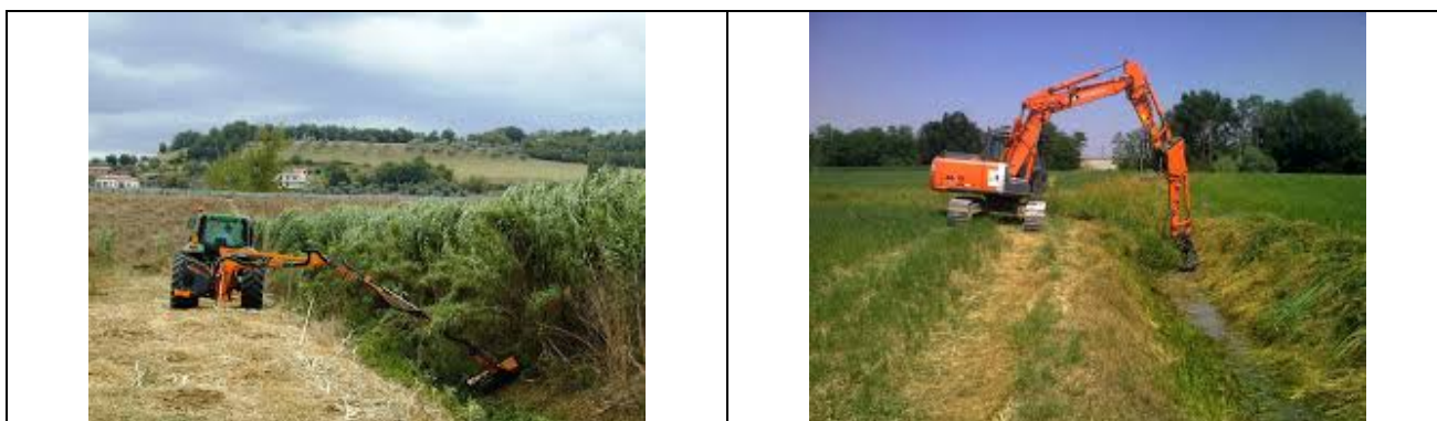
Figura 4. Diverse condizioni operative tipiche dello sfalci effettuato da trattori (a sinistra) ed escavatori (a destra).
