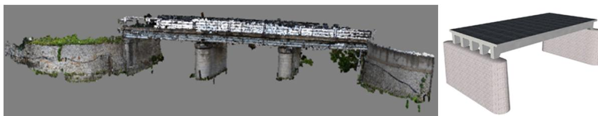
Figura 8 - Nuvola di punti e mesh rielaborata del ponte di San Gregorio
