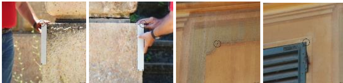
5-6-7-8) Ripresa topografica dei punti a terra del basamento e della zona bassa
